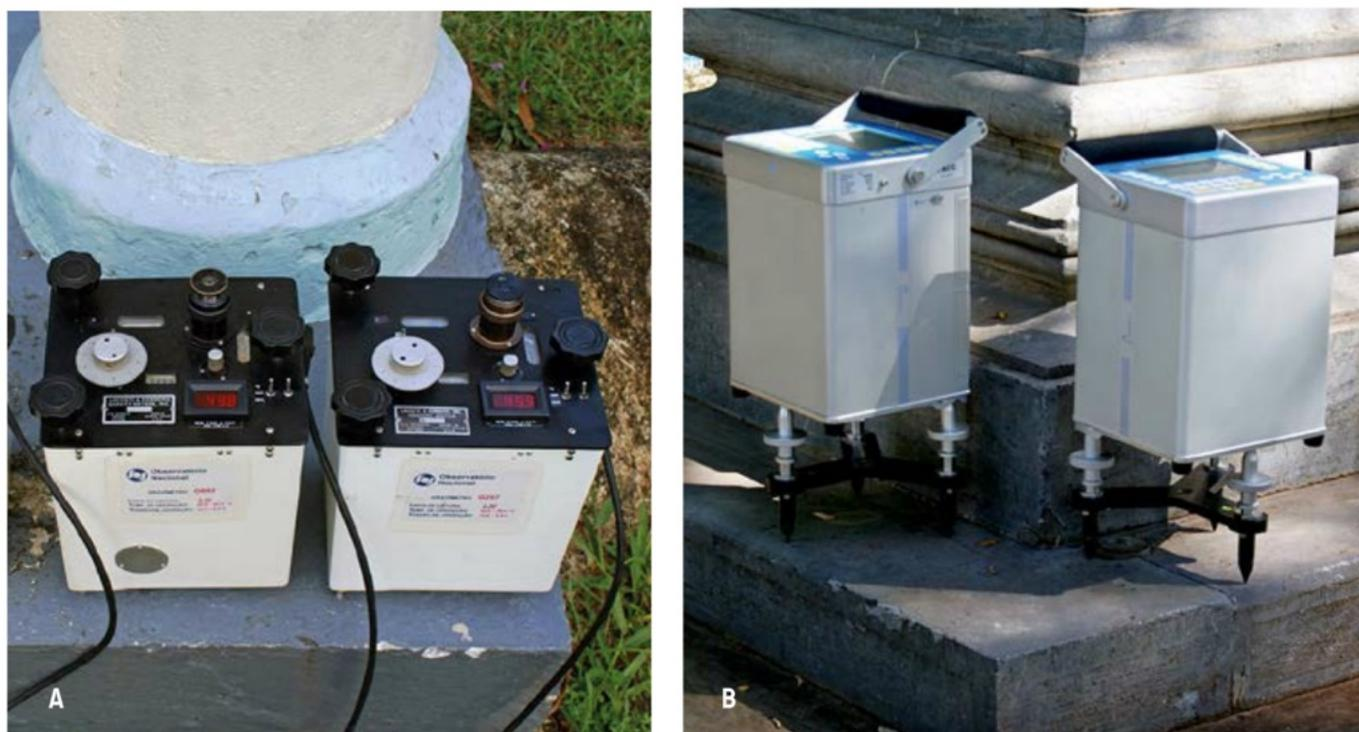
Figura 6. Gravímetros relativos (A e B) e absolutos (C e D) usados no Laboratório de Gravimetria do ON
