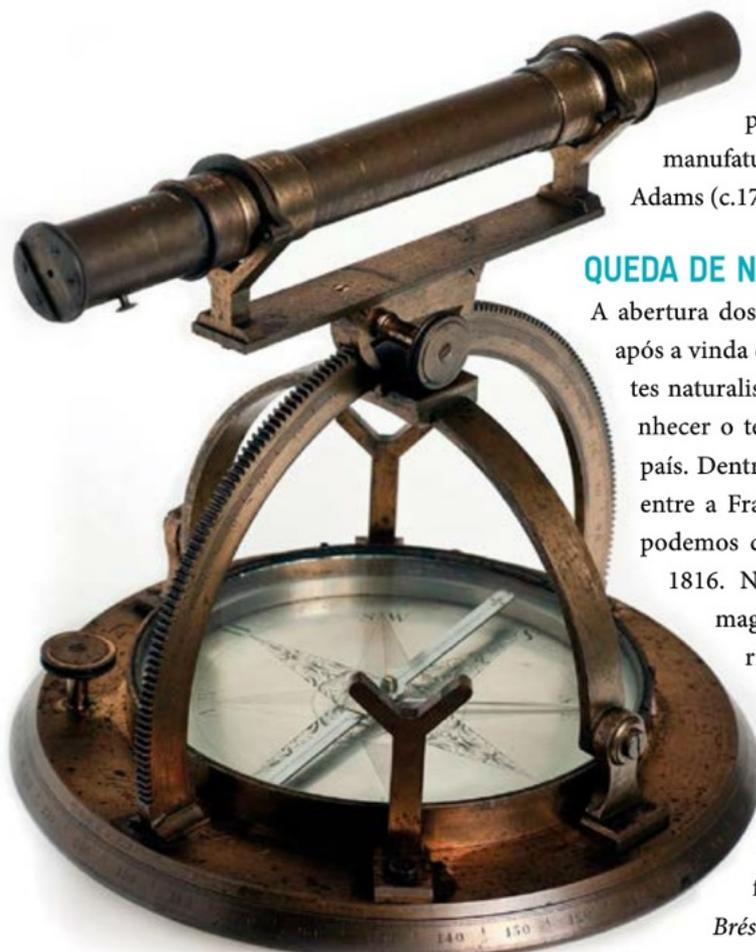
As medidas foram obtidas com uma agulha magnética de 15cm e 12g – instrumento que, apesar de simples, tinha boa qualidade de fabricação, manufaturado pelo construtor inglês George Adams (c.1709-1773), na Inglaterra (figura 4).
