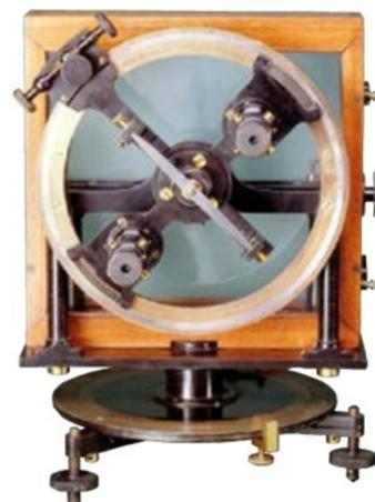
Figura 14. Inclinômetro Kew Pattern H. Barrow & E. W. Creak
